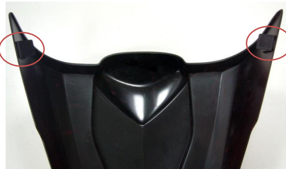
Montage 2 : pattes de fixation sur les côtés du capot
