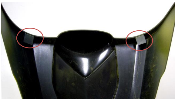
Montage 1 : pattes de fixation à l'avant du capot
